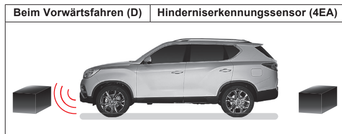
Vorderer Sensor arbeitet im Fahrmodus (D)
