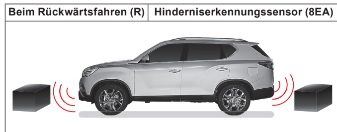
Sensoren vorne/hinten arbeiten im Rückfahrmodus (R)
